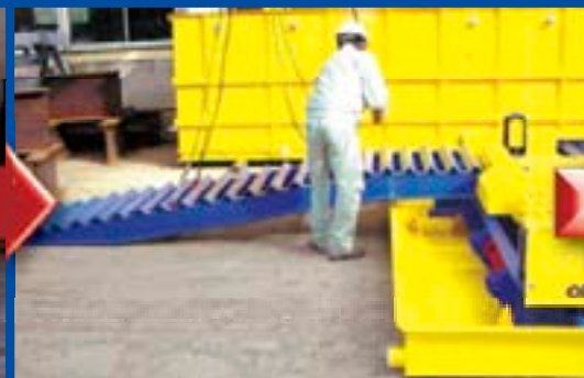
Монтаж въездных и выездных пандусов
