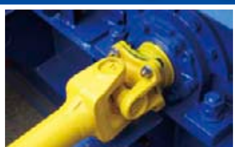
Внутренняя часть карданного вала
