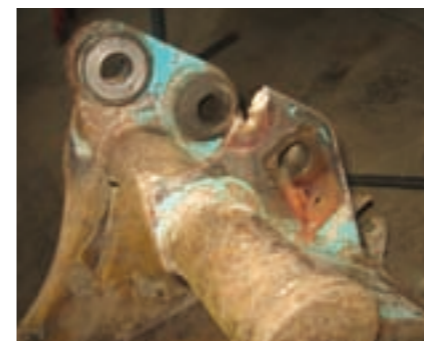
バケットブラケット破損
