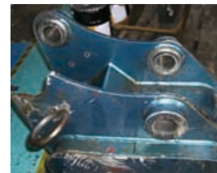
グラップルブラケット破損
