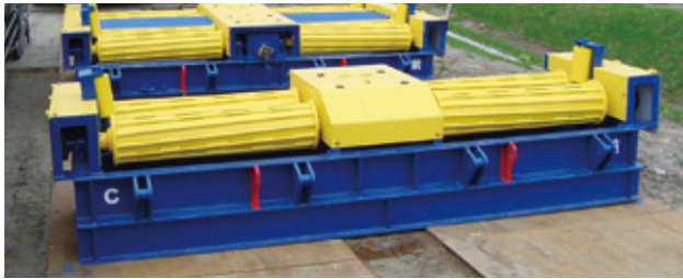
ローラー部分に八角鋼材を採用
