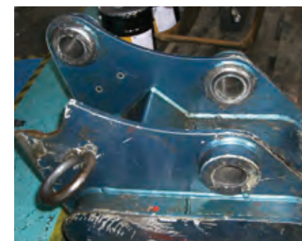
グラップルブラケット破損
