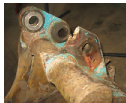
バケットブラケット破損
