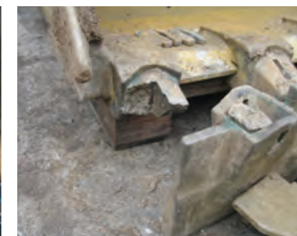
アダプター破損
