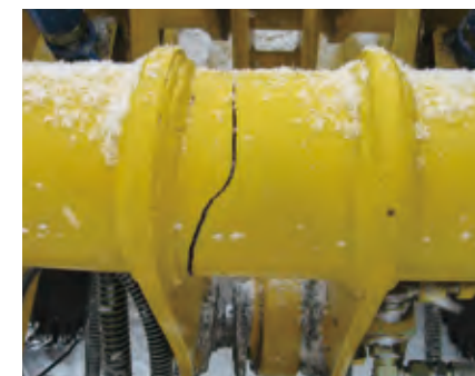
マルチカプラーパイプ亀裂
