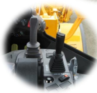
プラウ・シャッター操作は1本レバ ーで簡単に操作できます。
